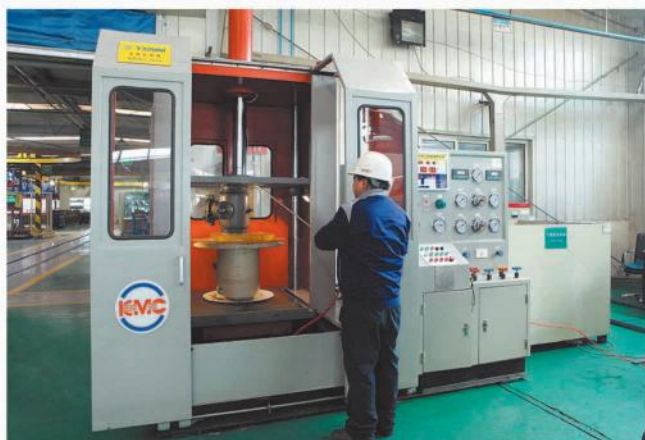
立式打压机（气压检测）
