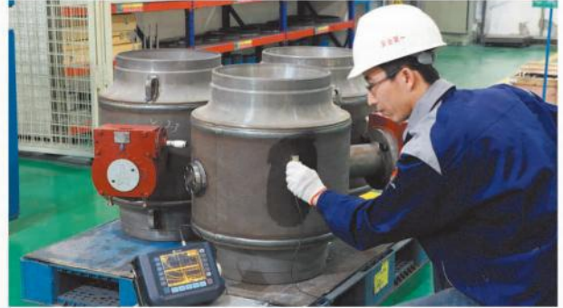
UT检测 (焊接处内部探伤检测)
