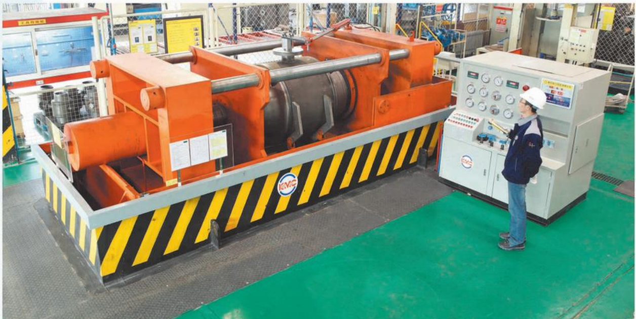
大型多功能潜水式打压机 (水压检测、气压检测)
