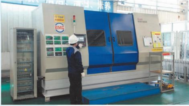
MT (荧光磁粉) (部件表面无损探伤检测)
