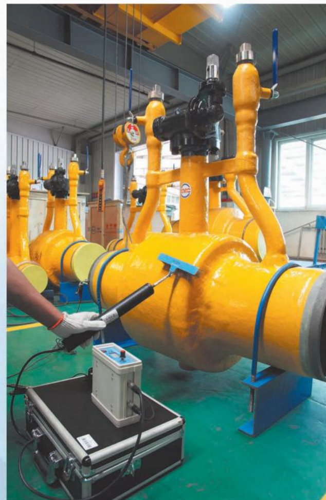
防腐电火花检测
