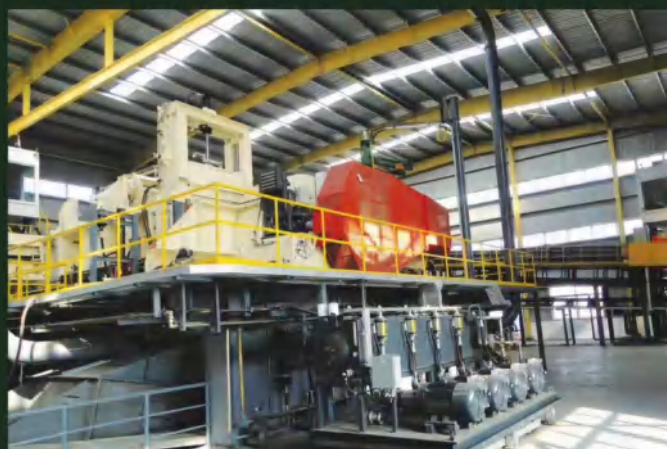
引进德国帕尔曼机械公司制造的长材刨片系统；
