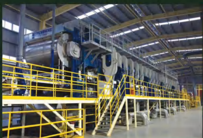
引进德国迪芬巴赫公司成套设备中的连续平压系统；
